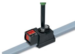
Contact avec le câble plat par serrage des vis. Merci d'observer le couple de serrage de 1 Nm !
