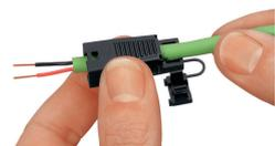
Passer le câble dans le boîtier de décharge de traction avant de connecter les fils.
