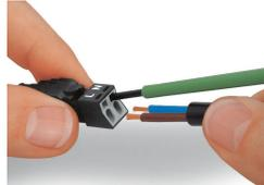
Actionner le ressort de serrage à l'aide d'un outil de manipulation dont la largeur de lame est de 2,5 mm et introduire le fil dénudé jusqu'en butée pour raccorder des conducteurs souples. La connexion des câbles rigides se réalise par insertion directe.
