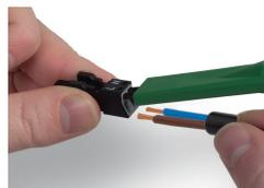
Pour le raccordement des conducteurs souples, ouvrir les deux ressorts de serrage à l'aide de l'outil de manipulation 890-382 et introduire le fil dénudé jusqu'en butée. La connexion des câbles rigides se réalise par insertion directe.
