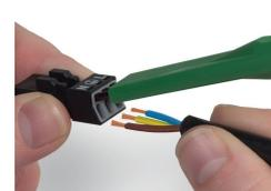
Pour le raccordement des conducteurs souples, ouvrir tous les ressorts de serrage à l'aide de l'outil de manipulation 890-383 et introduire le fil dénudé jusqu'en butée. La connexion des câbles rigides se réalise par insertion directe.
