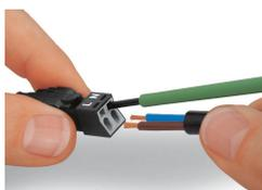
Actionner le ressort de serrage à l'aide d'un outil de manipulation dont la largeur de lame est de 2,5 mm et introduire le fil dénudé jusqu'en butée pour raccorder des conducteurs souples. La connexion des câbles rigides se réalise par insertion directe.
