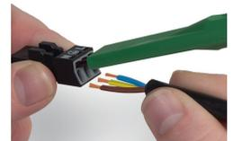
Zum Anschluss feindrätiger Leiter alle Klemmfedern mittels Betätigungswerkzeug 890-383 öffnen, und abisolierte Leiter bis zum Anschlag einführen. Eindrängige Leiter können direkt gesteckt werden.
