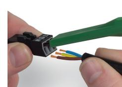
Pour le raccordement des conducteurs souples, ouvrir tous les ressorts de serrage à l'aide de l'outil de manipulation 890-382 et introduire le fil dénudé jusqu'en butée. La connexion des câbles rigides se réalise par insertion directe.
