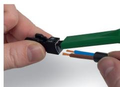
Pour le raccordement des conducteurs souples, ouvrir les deux ressorts de serrage à l'aide de l'outil de manipulation 890-382 et introduire le fil dénudé jusqu'en butée. La connexion des câbles rigides se réalise par insertion directe.
