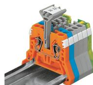
Für die Gruppenbeschriftung stehen nun neben dem Kunststoffbeschriftungsstreifen Gruppenschildträger für WMB-Beschriftungssystem zur Verfügung. Der Schildträger wird im Brückungsschacht montiert, wo er selbst dann noch Platz findet, wenn ein Kammbrücker gesteckt ist. Außer zur Gruppenbeschriftung leistet das Bauteil auch dann gute Dienste, wenn die seitlichen Beschriftungsaufnahmen der Klemme verdeckt sind. Der Schildträger ist in 5 mm, 10 mm und 15 mm Breite erhältlich.
