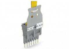
Leiste mit CAGE CLAMP®-Anschluss (0,25 ... 2,5 mm<sup>2</sup>) und Zugentlastungsplatte, wahlweise Beschriftung mit Mini-WSB oder WMB-Beschriftung
