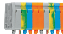
Barrettes à bornes avec pieds de fixation à encliqueter, pour épaisseur de tôle de 0,6 ... 1,2 mm Trou de fixation \varnothing 3,5^{+0,1} mm
