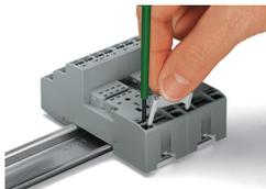
Brücken mit Schraubendreher lösen.
