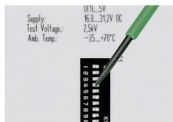
Configuration via micro-interrupteurs
