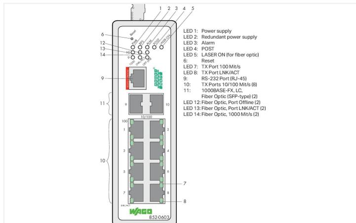
Le switch 852-603 est un switch industriel ETHERNET administrable avec 8 ports cuivre 10/100BASE-T et 2 slots pour adaptateur qui peut être configuré soit comme 100BASE-FX soit comme 1000BASE-SX/LX (les modules SFP sont disponibles sur demande).
