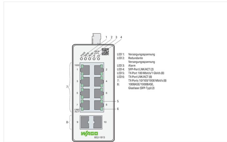
Der 852-1813 ist ein industrieller, konfigurierbarer ETHERNET-Switch mit 8 Ports 10/100/1000BASE-T und 2 Ports SFP 100BASE-FX/1000BASE-SX/LX/ZX (SFP-Module sind optional erhältlich).
