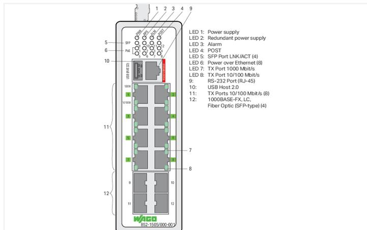
Le switch 852-1505/000-001 est un switch industriel ETHERNET administrable avec 8 ports 10/100/1000BASE-T qui supportent tous l'alimentation par Ethernet "Power over Ethernet" (PoE+) de 30W et 4 slots pour adaptateur SFP 1000BASE-SX/LX (les modules SFP sont disponibles sur demande). Les 8 ports PoE+ peuvent être exploités en parallèle.
