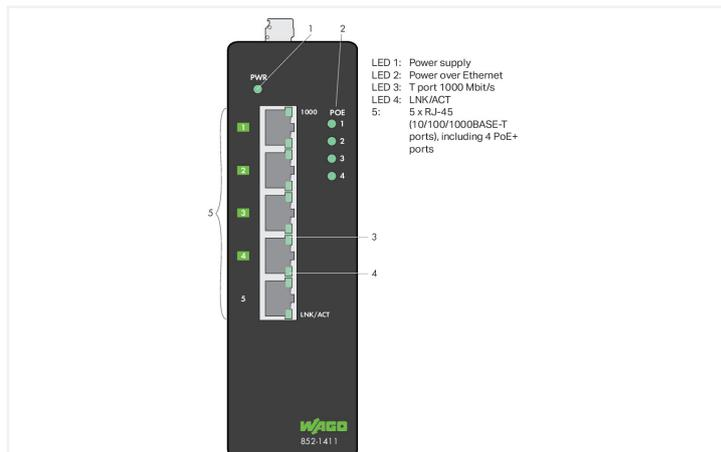
Le switch 852-1411 est un switch ETHERNET industriel non administrable avec 5 ports ETHERNET Gigabit, dont 4 ports supportent "Power over Ethernet" (PoE+) avec 30 W. Ces 4 ports PoE+ (IEEE 802.3at) peuvent être utilisés simultanément pour alimenter en énergie des équipements PoE (Powered Devices). Le convertisseur de tension intégré permet de fonctionner avec la tension d'alimentation 24 V DC usuelle dans l'armoire électrique.
