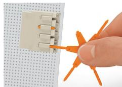
Codage d'un connecteur mâle THT en faisant glisser un détrompage.
