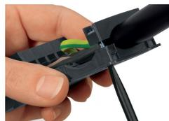
Serrer la décharge de traction à l'aide d'un tournevis.
