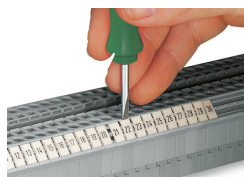
Encliquetage d'une bande de marquage WMB dans le logement de marquage
