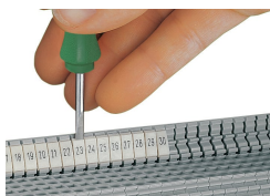
Encliquetage d'une bande de marquage WMB dans le logement de marquage du double porte-étiquettes
