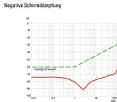
Das WAGO-Schirmanschlusssystem erhält seine hohe Wirksamkeit durch den Vorteil, die Schirmablage so nahe wie möglich an die Verbindungsstellen der abgeschirmten Leitungen heranzuführen zu können.
