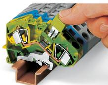
Schutzleiterklemmen lassen sich mit Querbrücken in einer Richtung (über die Klemmenrückwand) mit Durchgangsklemmen brücken. Zusätzlich zur Kennzeichnung dieser Klemmen empfehlen wir die Verwendung der gelbgrünen Querbrücker.
