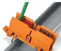
Den Befestigungsadapter von der Tragschiene lösen.
