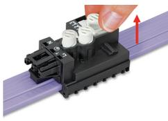
Un déblocage est possible en soulevant l'élément rotatif. Le changement de position de cet élément permet de sélectionner la nouvelle phase.
