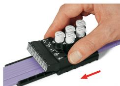
Monter le module IDC (raccordement par perçage d'isolant) à fleur sur la pièce inférieure. Si cela n'est pas possible à cause du codage bloquant, il faut tourner la partie supérieure de 180° et la monter.
