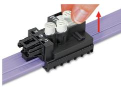
Un déblocage est possible en soulevant l'élément rotatif. Le changement de position de cet élément permet de sélectionner la nouvelle phase. Attention : ne pas utiliser sur le même endroit du câble plat !
