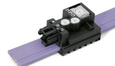
Après avoir établi le contact avec le câble plat, le sélecteur est bloqué et ne peut plus être déplacé même après le desserrage de l'élément rotatif !
