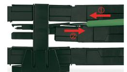
Toutes les connexions du distributeur sont directement verrouillées après l'enfichage pour éviter un démontage accidentel. Déverrouillage à l'aide d'un tournevis quels que soient le nombre et la position des connecteurs mâle/femelle.
