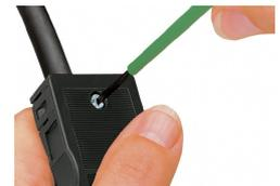
Zugentlastungsschraube mit Schraubendreher (Klingenbreite 2,5 mm) anziehen.
