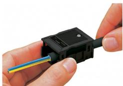
Wir empfehlen vor Anschluss der Leiter das vorgebastete Zugentlastungsgehäuse über die Leitung zu schieben. Die Zugentlastung kann jedoch auch nachträglich montiert werden.
