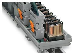
Stiftleisten mit geraden Einlötschrauben und 1-Leiter-Federleisten (hier am Beispiel eines Relaisbausteins)
