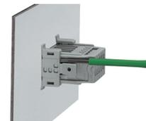
Pour démonter, introduire l'outil de manipulation (lame 2,5 mm) dans l'encoche de démontage.
