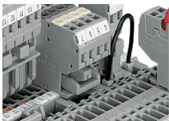
Schachtelbrücker in 2-Leiter-Federleiste und Querbrücker in Basisklemmen
