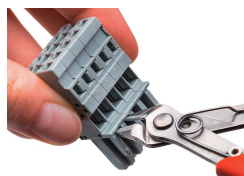
Kodierung einer Federleiste – Kodiernase (n) mittels Schneidwerkzeug entfernen. Die 1. und letzte Rastkodiernase nicht entfernen oder zusätzlich Verriegelungsklinke verwenden.
