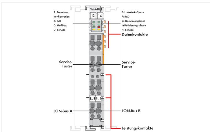
Das LON-FTT-Modul 753-648 ist konform zum Standard ISO/IEC 14908. Das 12 mm breite Modul dient zur LON-Anbindung an Controller und I/O-Modulen der Serie 750 (BACnet, KNX, EnOcean, DALI, MODBUS und weitere). Es ist in einem LonWorks FT- oder LP-Netzwerk ein vollwertiges und flexibles LON-Gerät. Das Netzwerkvariablen-Interface bietet die Möglichkeit, 249 Netzwerkvariablen beliebigen Typs zu definieren und unterstützt LonMark-Objekte und „Configuration Properties“.
