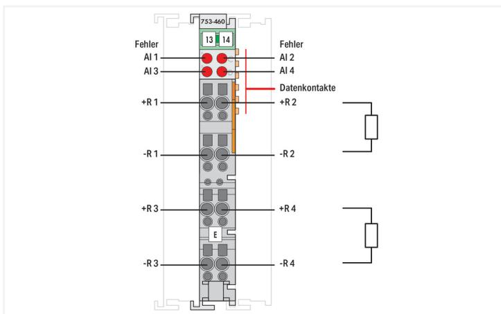
Das Analogeingangsmodule erlaubt den direkten Anschluss von Pt-Widerstandssensoren.
