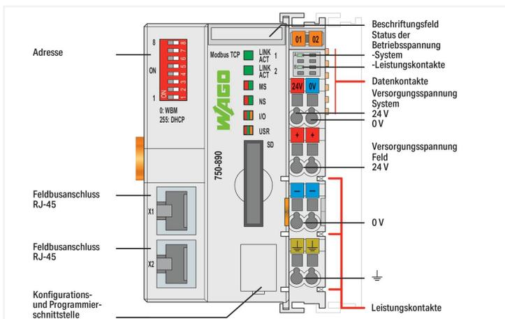
In Verbindung mit dem WAGO-I/O-SYSTEM kann der Modbus TCP-Controller als programmierbare Steuerung in ETHERNET-Netzwerken eingesetzt werden.
