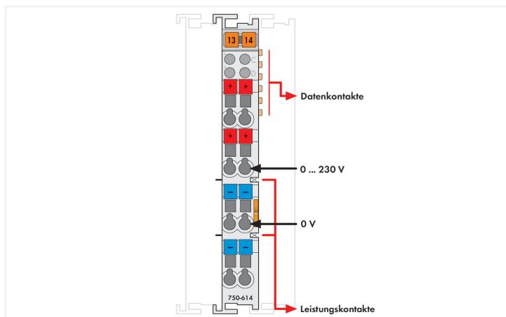
Die Potentialvervielfältigungsklemme dient zum mehrfachen Abgriff der Versorgungsspannung.
