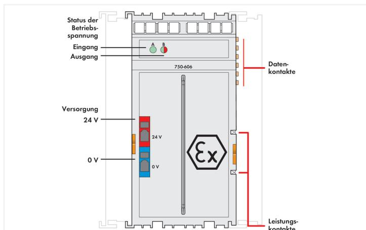
Das Einspeisemodul dient dazu, alle eigensicheren Module Ex i der Serie 750 zu versorgen. Es überwacht die Spannungsversorgung des nachgeschalteten Segments Ex i und trennt den eigensicheren vom nichteigensicheren Teil des WAGO-I/O-SYSTEMs 750. Ein- und Ausgangsseite sind dabei galvanisch getrennt ausgeführt.
