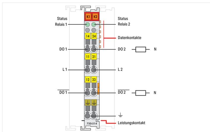
Über das Digitalausgangsmodul werden Steuersignale aus dem Automatisierungsgerät an die angeschlossenen Aktoren weitergegeben. Zur Ansteuerung der Relais wird die interne Systemspannung genutzt. Die Kontakte sind potentialfrei angeordnet. Der Ansteuerungszustand des Relais wird über LED signalisiert.
