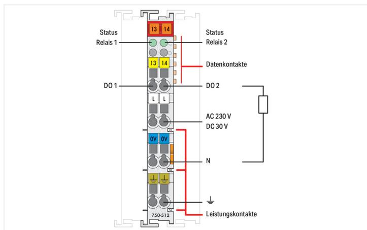
Über das Digitalausgangsmodul werden Steuersignale aus dem Automatisierungsgerät an die angeschlossenen Aktoren weitergegeben. Zur Ansteuerung der Relais wird die interne Systemspannung genutzt. Jeweils ein bzw. zwei Kontakte sind über die Leistungskontakte mit einem Pol der feldseitigen Spannungsversorgung (z.B. + oder ~) verbunden. Der Ansteuerungszustand des Relais wird über LED signalisiert. **Achtung:** Für die Versorgung mit AC 250 V/ DC 30 V ist ein zusätzliches Einspeisemodul zu setzen!
