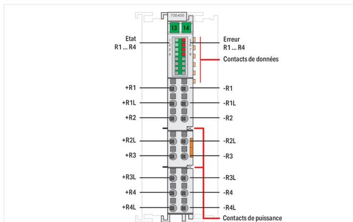
Cette borne d'entrées analogiques permet une connexion directe de sondes de température Pt ou Ni, des capteurs résistifs ainsi que des potentiomètres.
