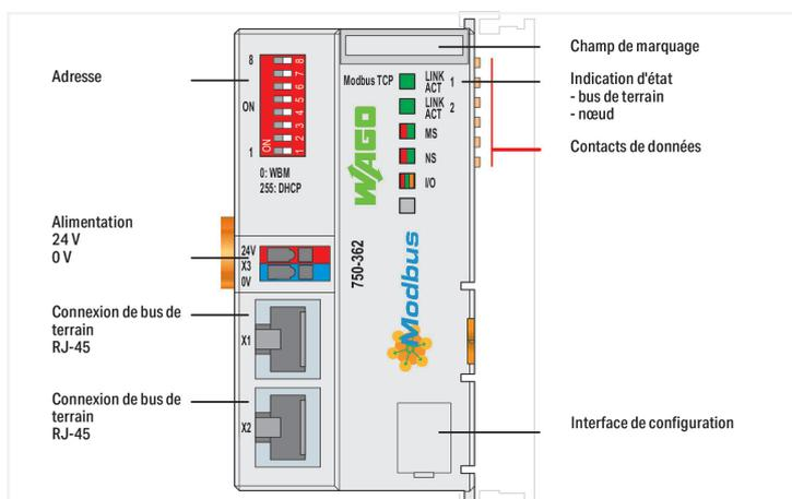
Le coupleur de bus de terrain Modbus TCP/UDP 750-362 relie le système modulaire WAGO-I/O-SYSTEM avec ETHERNET.
