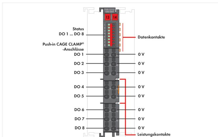
Das Digitalausgangsmodul verfügt bei nur 12 mm Baubreite über 8 Kanäle in 2-Leiter-Anschluss-technik. Es gibt binäre Steuersignale aus dem Automatisierungsgerät an die angeschlossenen Aktoren (z. B. Magnetventile, Schütze, Geber, Relais oder andere elektrische Lasten) aus.
