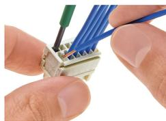
Leiter anschließen – Betätigung des CAGE CLAMP®-Anschlusses mit Schraubendreher (2,5 x 0,4) mm – aus Leiteranschlussrichtung
