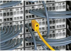
Prüfen mit Prüfstecker (210-137) Ø 2,3 mm
