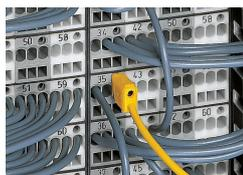
Prüfen mit Prüfstecker (210-137) Ø 2,3 mm
