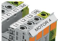
Beschriftungsadapter (285-442) für Beschriftungsstreifen (2009-110) bzw. 2 WMB-Schilder für Klemmen 285-13x, 285-15x und 285-19x
