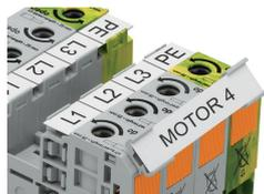
Beschriftungsadapter (Bestellnr. 285-442) für Beschriftungsstreifen (Bestellnr. 2009-110) bzw. 2 WMB-Schilder für Klemmen 285-13x, 285-15x und 285-19x
