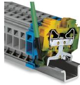
Aufschnappen auf die Tragschiene Schutzleiterklemmen werden wie Durchgangsklemmen auf die Tragschiene aufgeschnappt. Dabei wird die Kontaktierung zur Tragschiene ohne zusätzliche Handhabung automatisch sichergestellt. Ein seitliches Verschieben auf der Tragschiene im aufgeschnappten Zustand ist nicht möglich.
